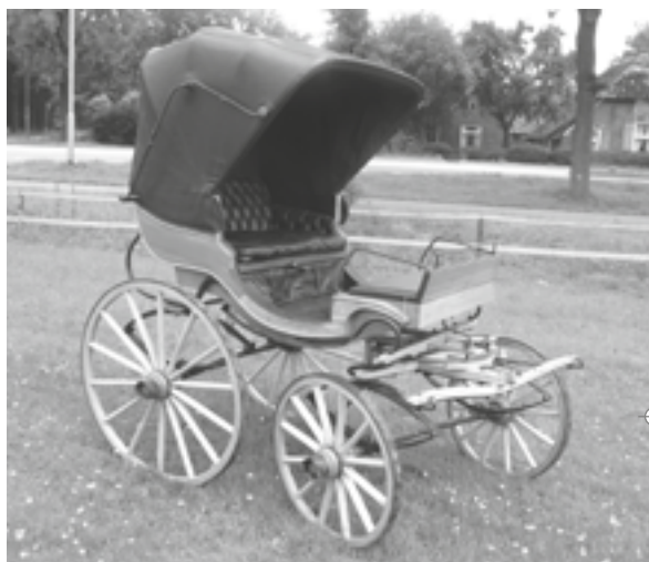
✦ BERTUS VAN DEN BOSCH MAAKTE ZELF DE HOUTEN WIELEN, SPAKEN EN ANDER HOUTWERK VOOR DE RESTAURATIE VAN DEZE WAGEN.
